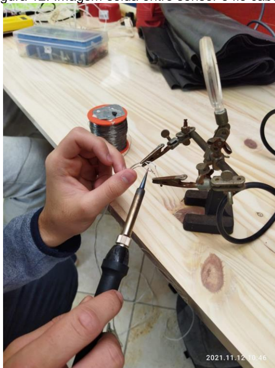
Figura 12: Imagem solda entre sensor e fio cabo paralelo.
